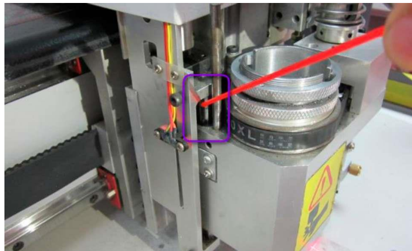
Змащення лінійного підшипника осі Z
