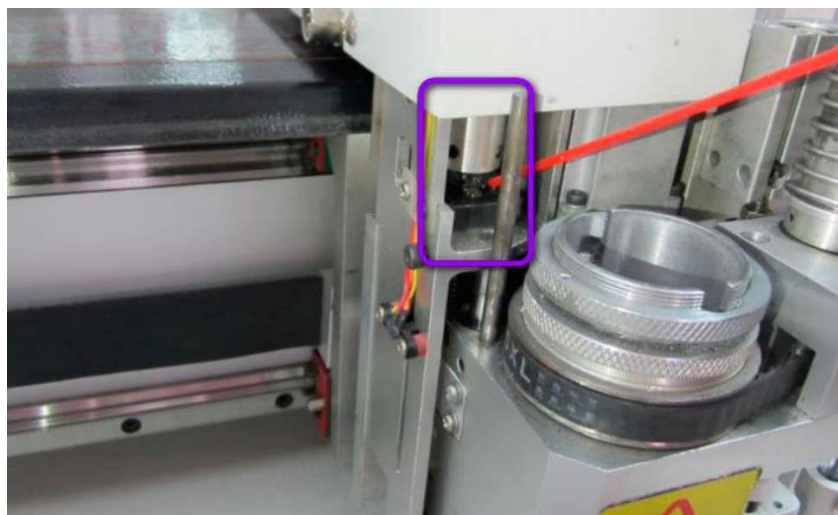
Змащення гвинтового підшипника осі Z
